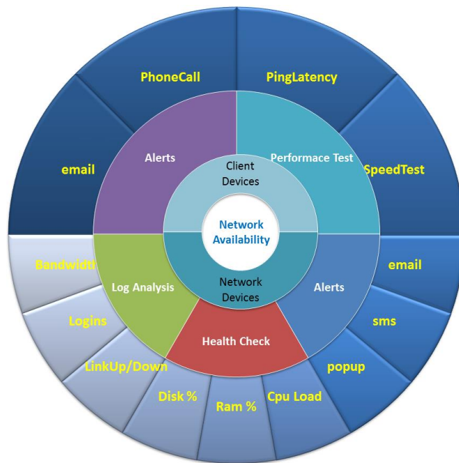
圖 6、網路品質監控系統概念圖
