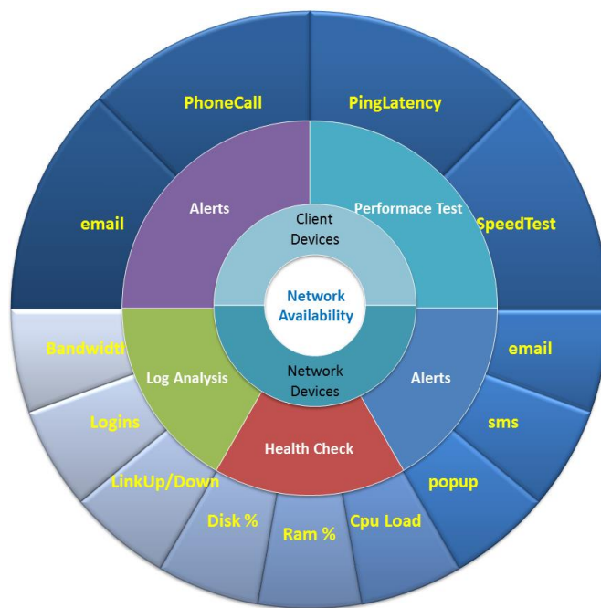
圖 6、網路品質監控系統概念圖
